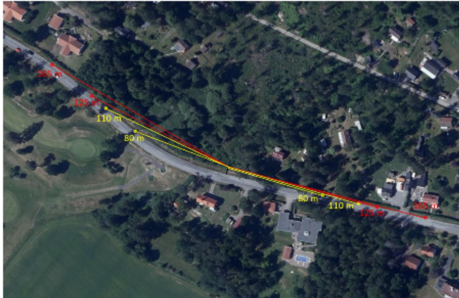
Bild 15: Siktkrav som ska uppfyllas för in- och utfart i föreslaget läge. Röda streck motsvarar för hastighet 70 km/tim och gula för hastighet 50 km/tim. Bild ur siktutredningen, Tyréns.
