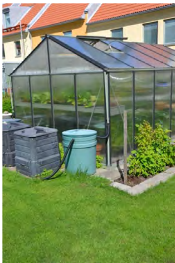
Figur A. Exempel på LOD. Till vänster uppsamling och användning till bevattning. Eventuellt överskott infiltrerar. Till höger exempel på genomsläpplig parkeringsyta. Foto Linköpings kommun.
