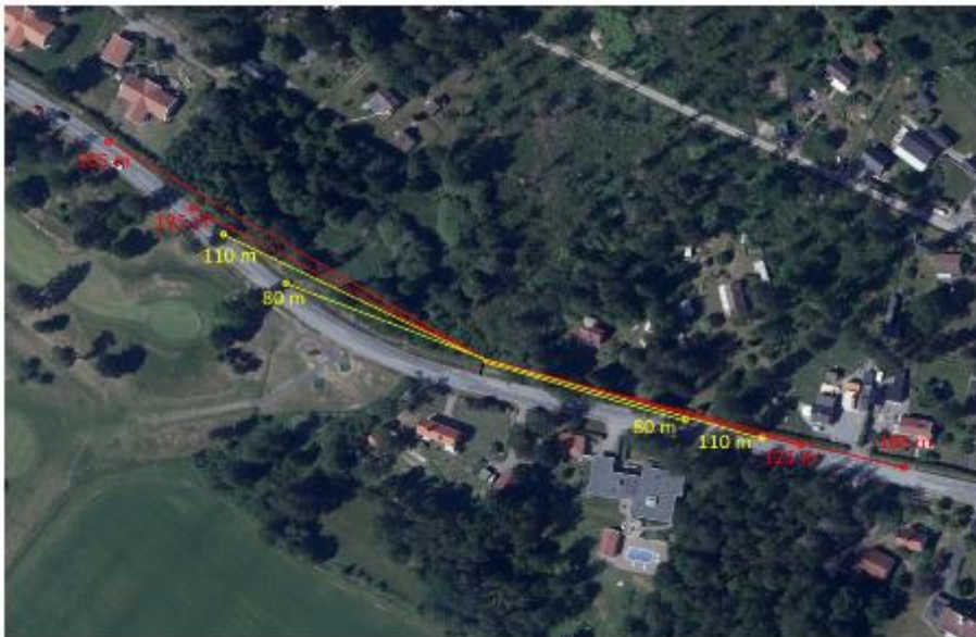
Bild 16: Siktkrav som ska uppfyllas för in- och utfart i föreslaget läge. Röda streck motsvarar för hastighet 70 km/h och gula för hastighet 50 km/h. Bild ur siktutredningen, Tyréns.
