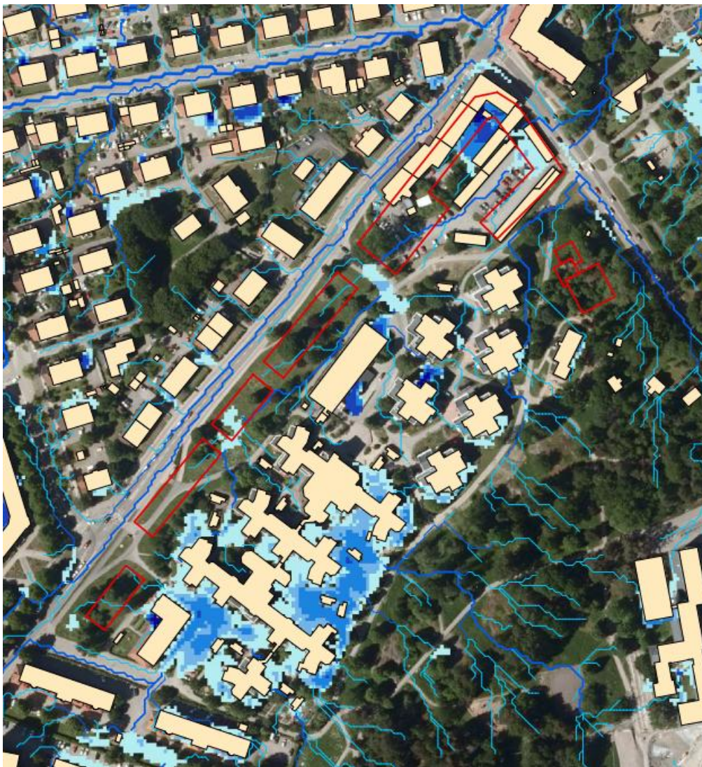
Figur 7 Skyfallskartering och rinnvägar vid ett 100-årsregn
