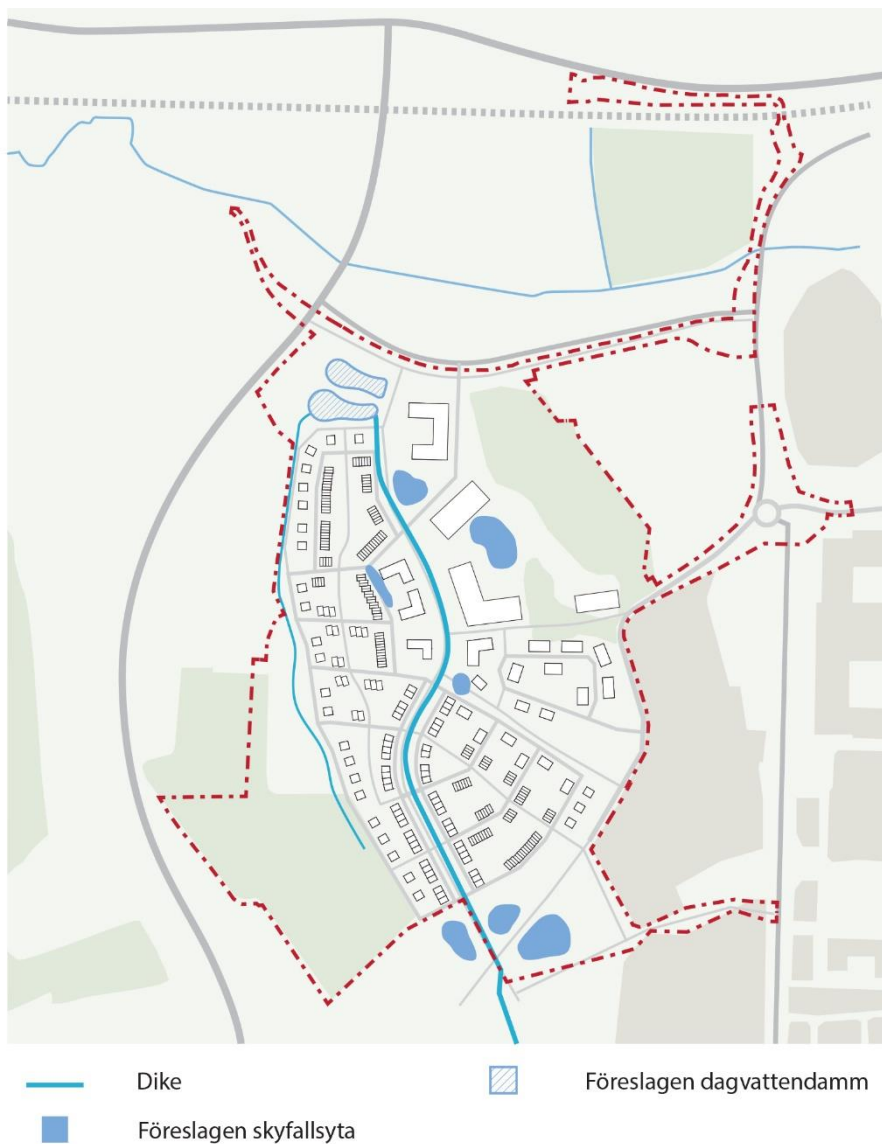
Bild 32. Kartbild med princip för dagvattenhantering. Byt bild, västra diket ska illustreras längre söderut.
