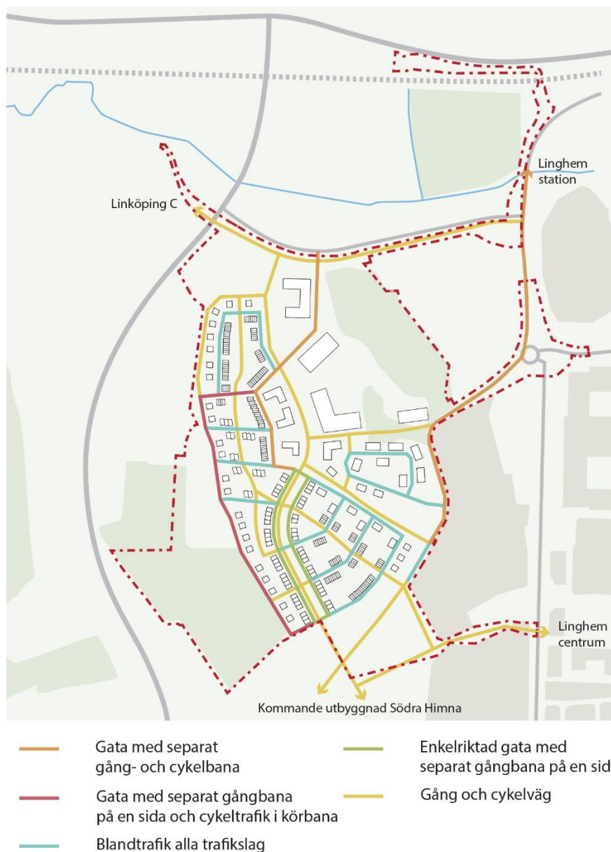
Bild 29. Illustrationskartan visar föreslagen gång- och cykelstruktur inom Norra Himna. Park- och skyfallsstråket som redovisas med grön linje innehåller en gång- och cykelväg.
