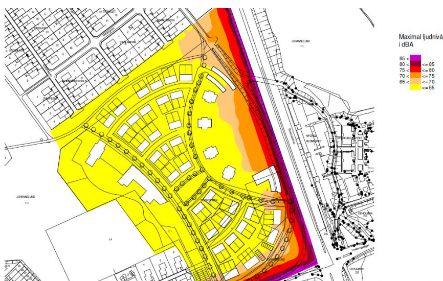
Bild 14: Maximal ljudnivå enligt tidigare gjord bullerutredning, kommer ersättas med ny inför granskning.
