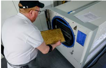
2. Plåtarna hämtas från frysen och placeras i frystorkningsmaskinen och kökschef Robert Cedergren knappar in det program som gäller. Maskinen är uppkopplad mot internet och en tekniker kan följa hela processen.
