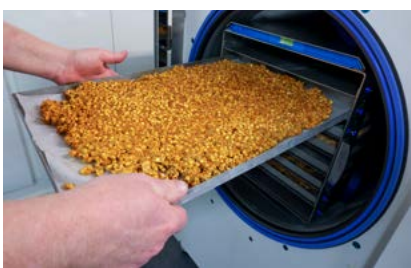
4. När maten har frystorkats, det tar minst ett dygn, bibehålls formen på ingredienserna, men genom att vattnet inte finns kvar så blir resultatet sprött och det väger betydligt mindre.
