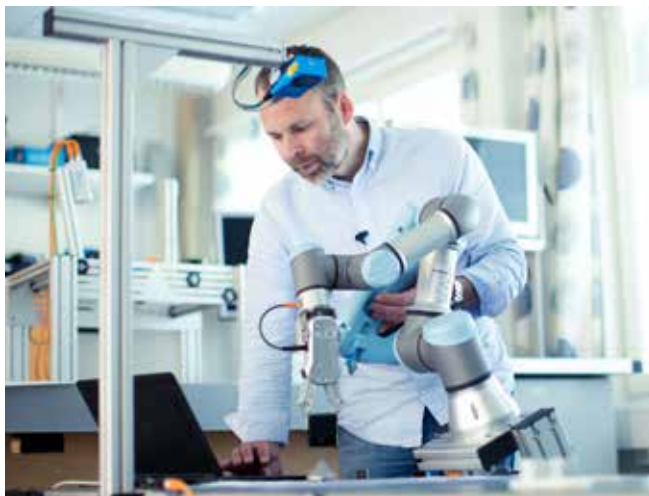
SICK IVP i Linköping ligger i utvecklingsfronten inom robotik och Deep Learning. Här kalibreras en robot mot en visionkamera.
